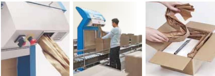
El convertidor moldea papel kraft de una sola capa en una configuración de papel en forma de estrella de gran volumen que se puede utilizar como material de relleno efectivo. Impide que los productos se muevan dentro de la caja, garantizando que lleguen sin daños a su destino final. El papel convertido se suministra directamente en el punto de operación, mejorando la eficiencia del proceso de embalaje y optimizando la velocidad de trabajo.
